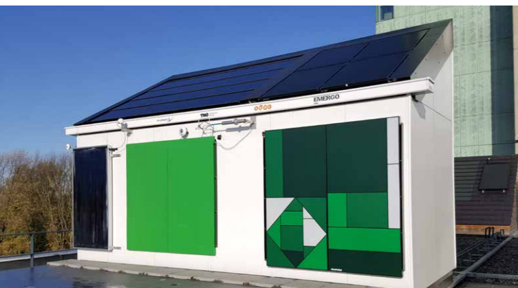
Testlocatie van het FITS gevelsysteem bij het Solar Energy Application Centre of TNO
